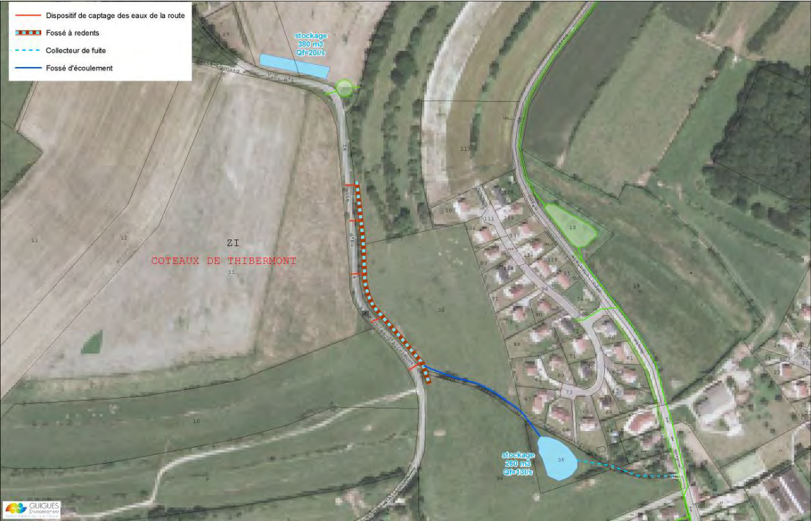
Carte 16 : Schéma de principe d'aménagement de la rampe de l'épinette – 3 ème solution
