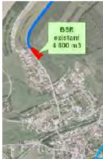
Figure 9 : Bassin de rétention considéré transparent pour une crue de 100 ans
