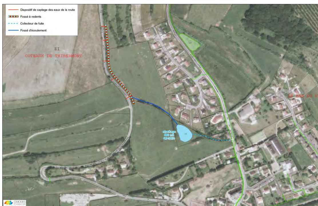
Carte 14 : Schéma de principe d'aménagement de la rampe de l'Epinette – 1 ère solution
