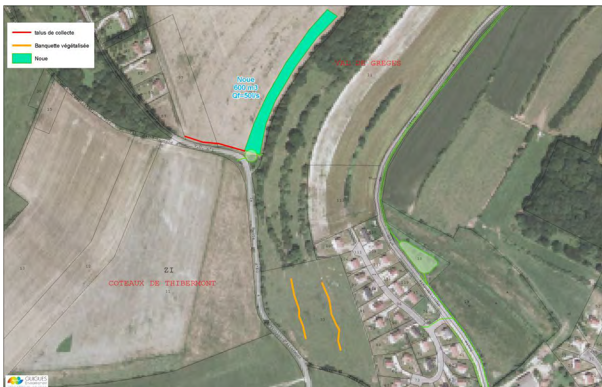
Carte 17 : Schéma de principe d'aménagement de la rampe de l'EpINETTE – 4 ème solution
