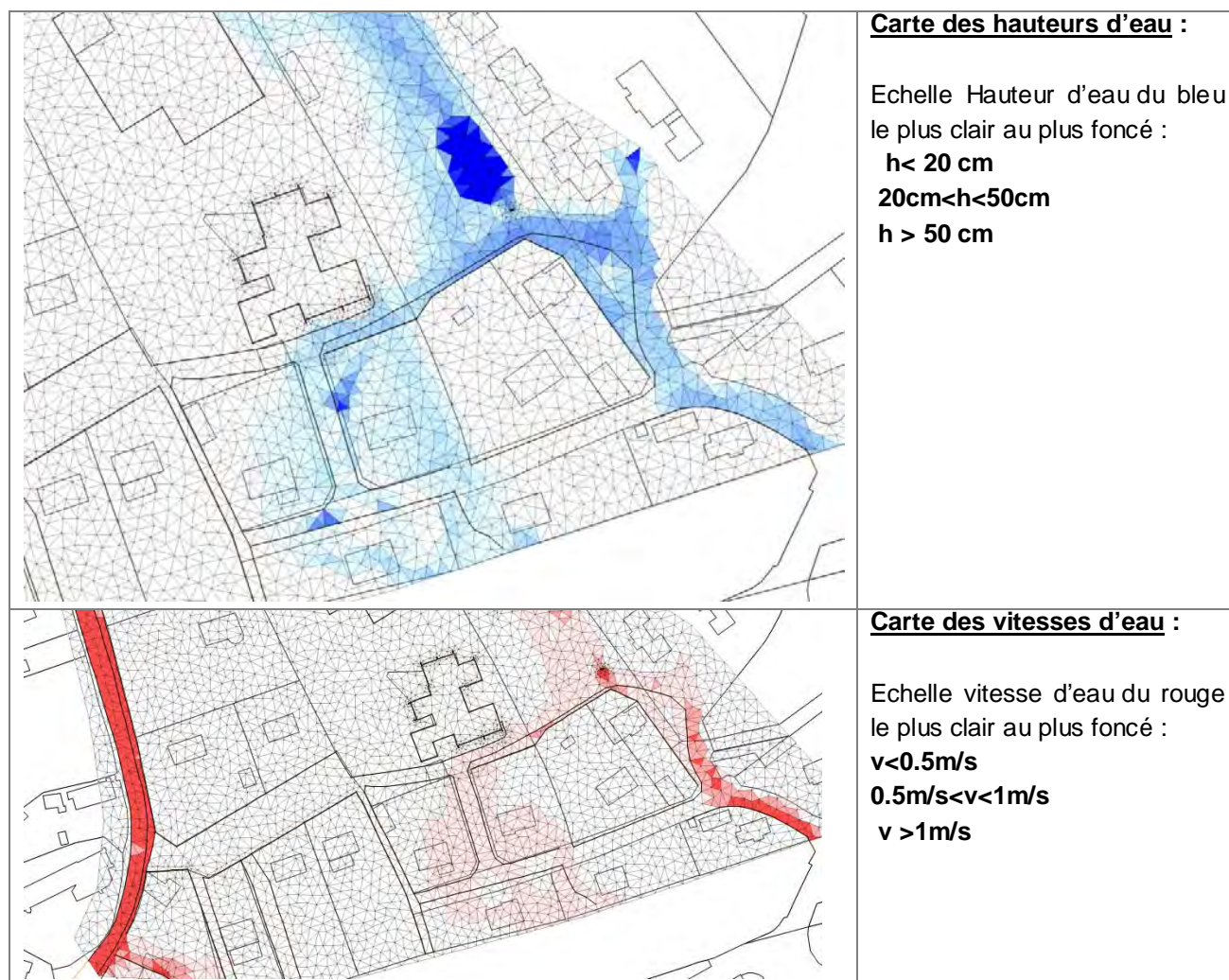
Figure 14 : Ecoulement de la crue de 100 ans au niveau du gymnase et du nouveau parking
