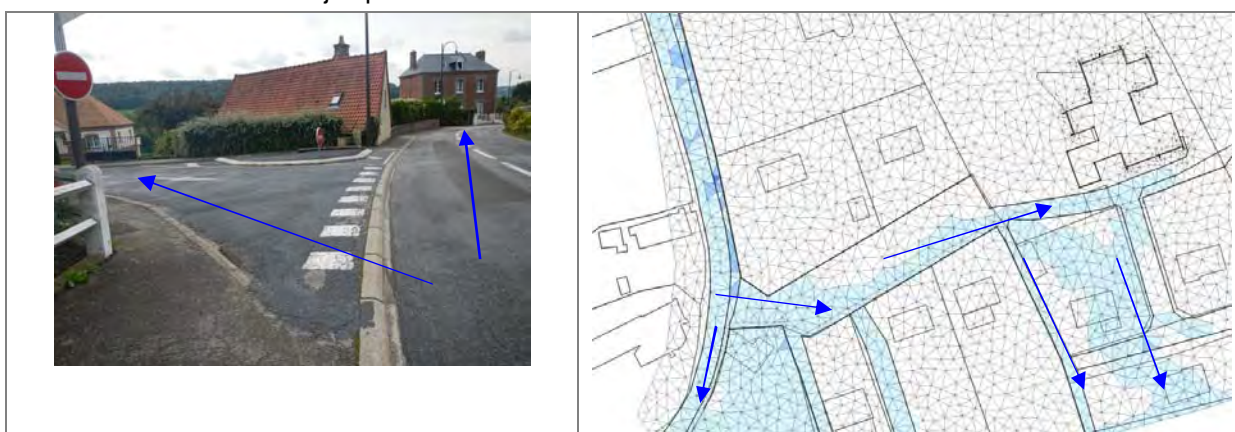
Figure 11 : Ecoulement de la crue de 100 ans dans l'impasse des Briches
