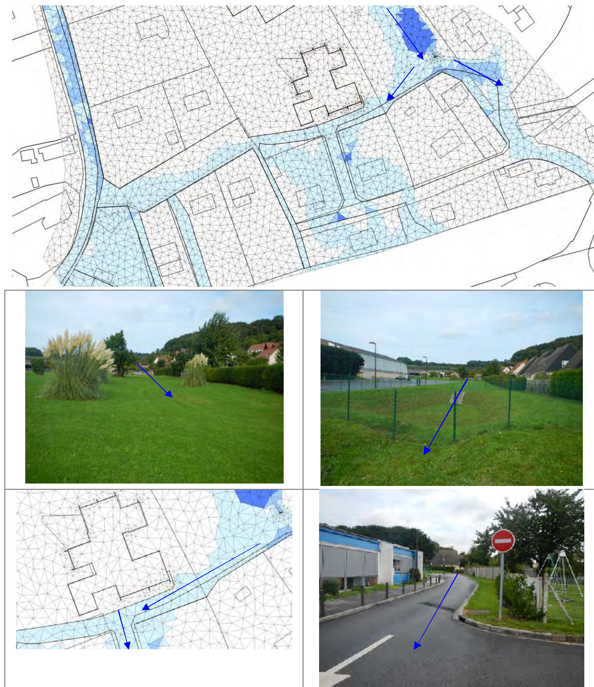
Figure 13 : Ecoulement de la crue de 100 ans au niveau du gymnase et du nouveau parking
